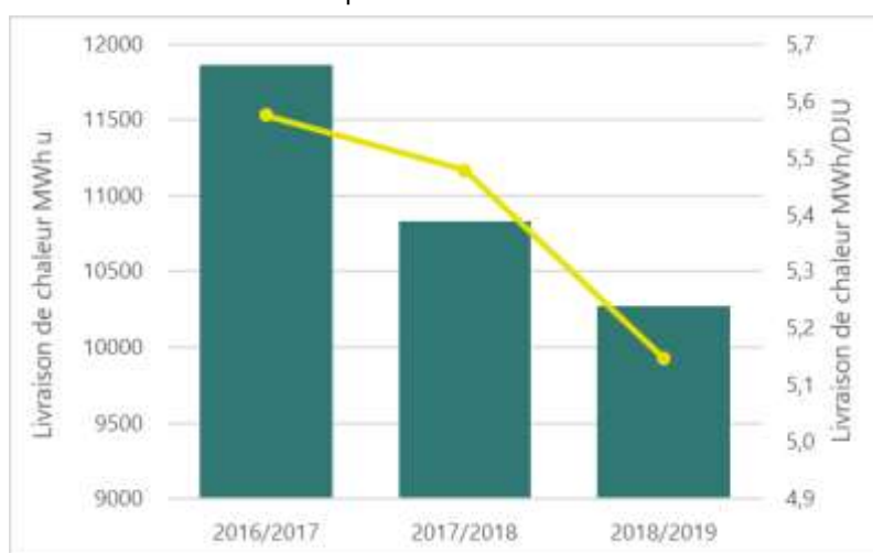
Figure 24 – Livraison de chaleur du réseau Coulaines-Bellevue
