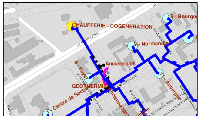
Position de la centrale géothermique sur le réseau
