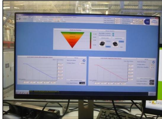
Une gestion technique centralisée est mise en place et supervise les différents générateurs (chaufferie gaz, centrale géothermique et cogénération) ainsi que l'ensemble des sous-stations.
