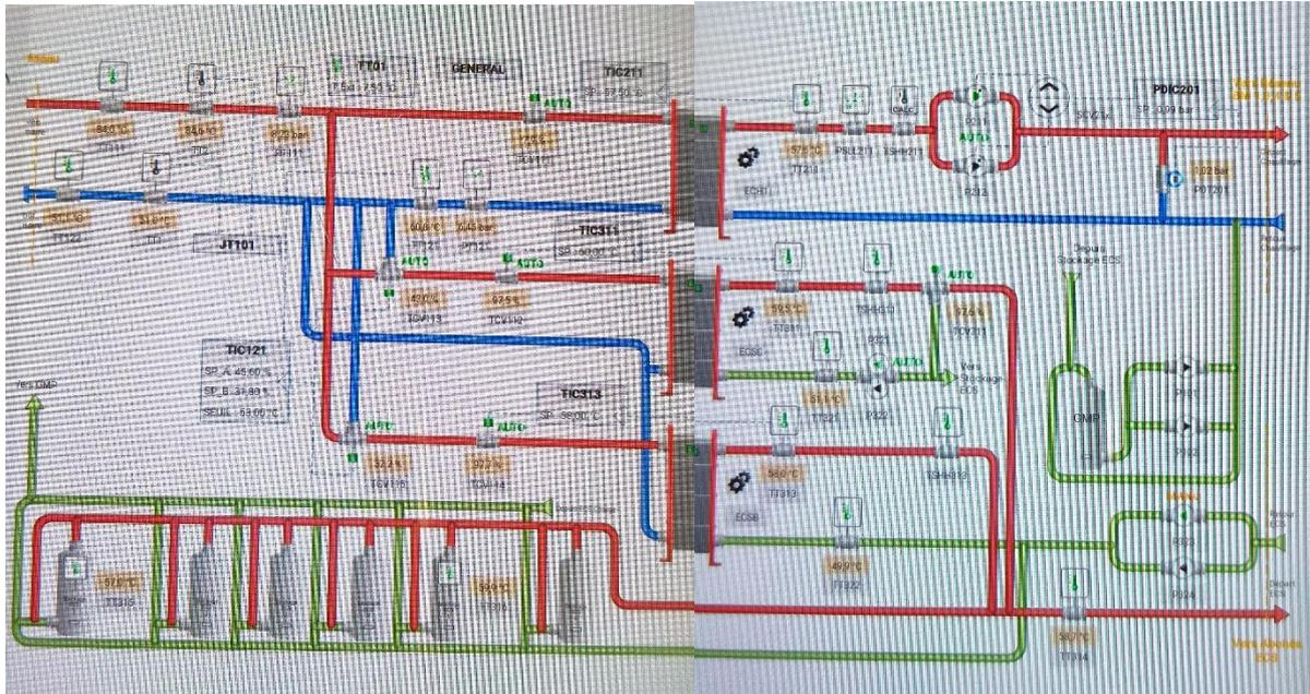
Dans la sous-station « **Terrasse de l'abbaye** », mise en service en Mars 2021, on note qu'il n'y a ni troisième tube ni cascade réalisée pour limiter la température de retour.
