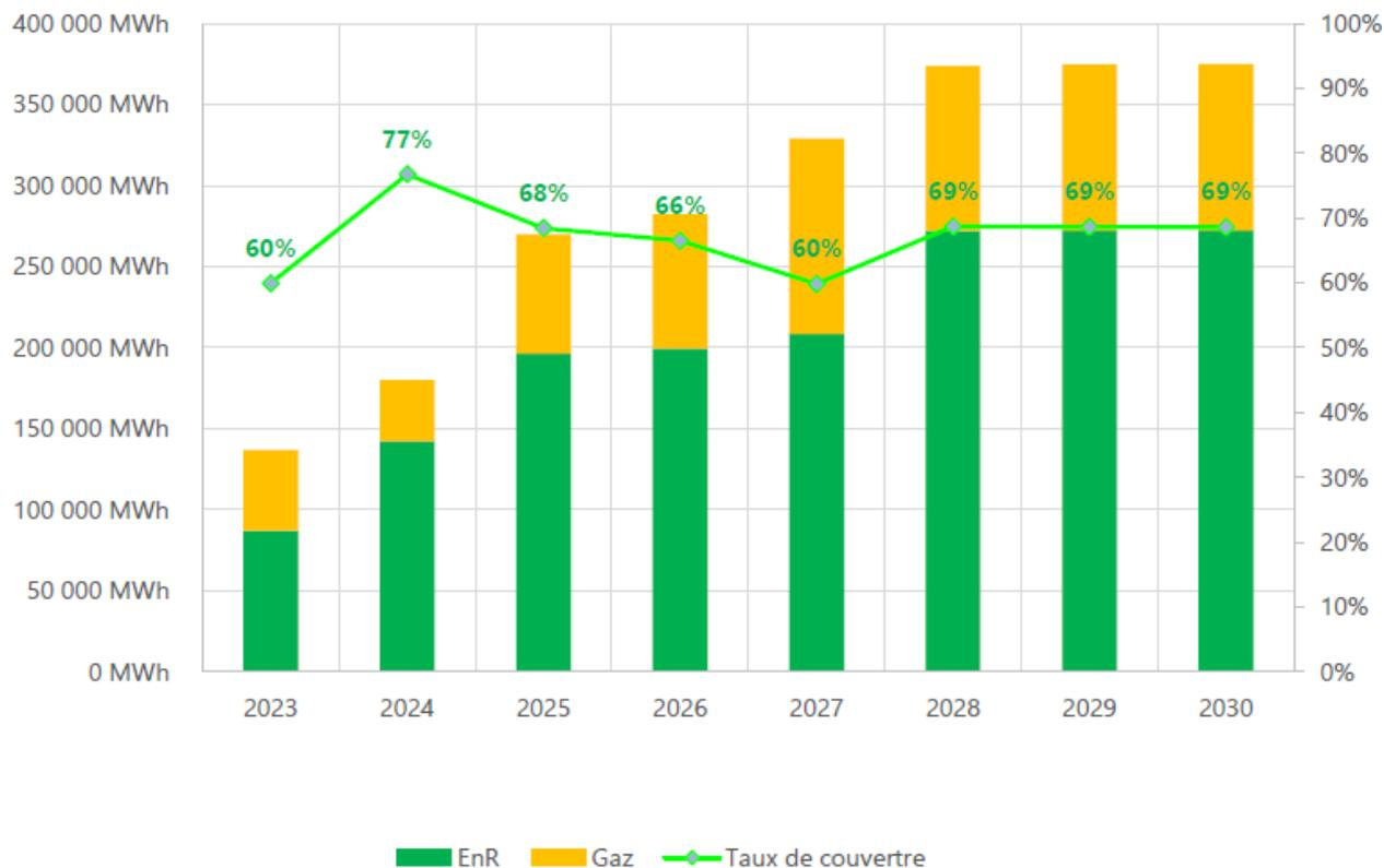
Figure 80 : Production et taux d'EnR&R visée pour le Réseau de la SEER
