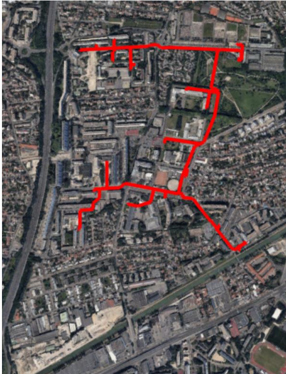
Figure 15 : Plan non détaillé du réseau de chaleur de la Ville de Bondy avant extension vers la ZAC rives de l’Ourcq
