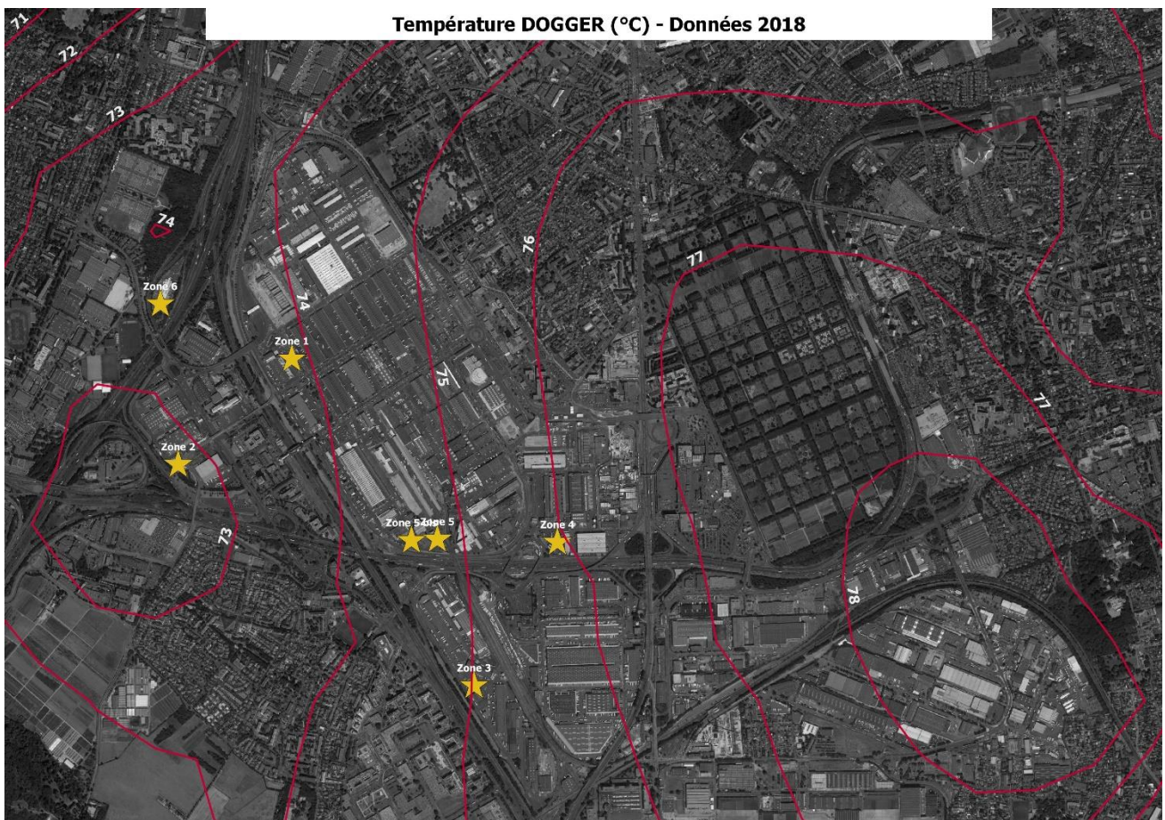
Figure 29 - Courbes lissées d'iso température au toit du Dogger
