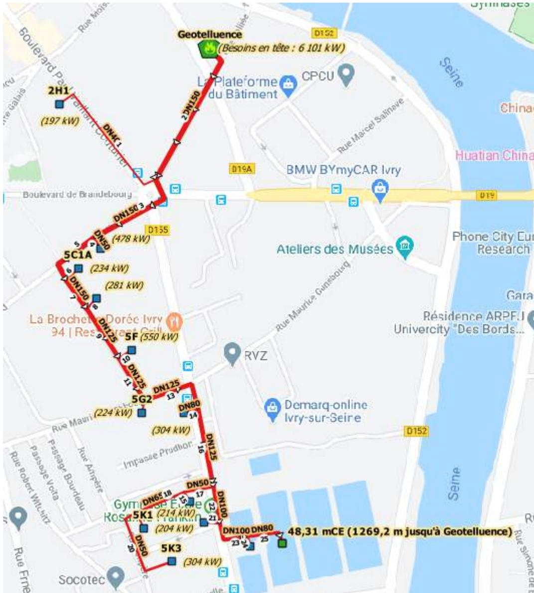
Figure 79: Estimation du dimensionnement du réseau pour le raccordement de l'usine des eaux
