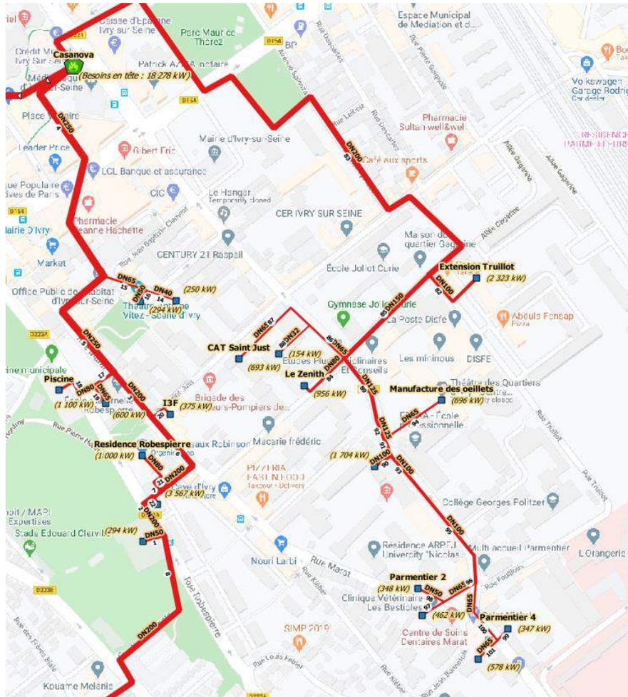
Figure 61: Dimensionnement du scénario "Charles Foix" avec raccordements limités
